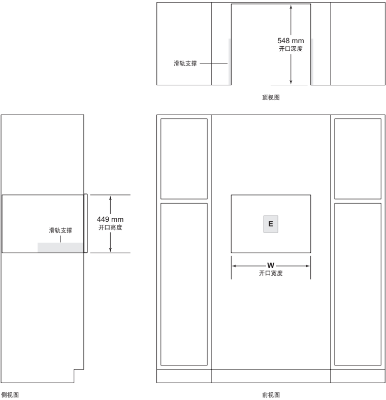
注：610 mm 型号和带 762 mm 饰件的型号要求相同的开口尺寸。
