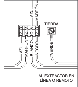
Cableado del extractor en línea/remoto
