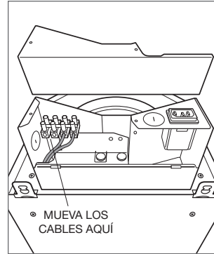
Ubicación del cableado
