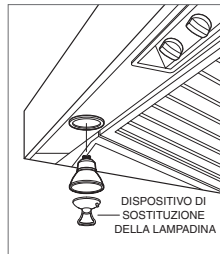
Installazione della lampadina.
