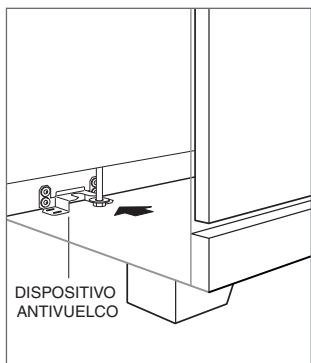
Ubicación del dispositivo antivuelco.
