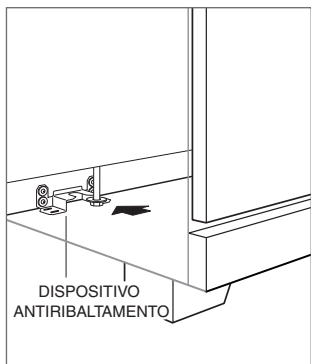
Posizione del dispositivo antiribaltamento
